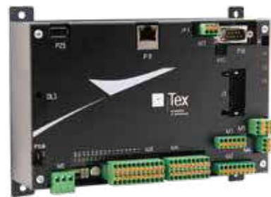
Controllo PAC (Programmable Automation Controller) che include funzioni HMI + PLC + Motion Control come posizionatore, estesa connettività al campo, adatto per piccole automazioni quali troncatrici, macchine avvolgitrici, sistemi di verniciatura, macchine per calzature e lavorazione della pelle, distributori automatici, sistemi di supervisione, tavole girevoli, macchine speciali...
