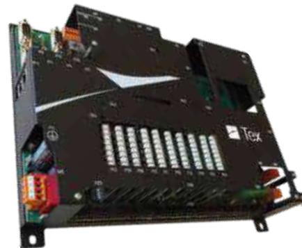
Controllo PAC (Programmable Automation Controller) che include funzioni HMI + PLC + Motion Control fino a ventotto assi interpolati, estesa connettività al campo inclusi EtherCAT e Mechatrolink come opzioni per automazioni dove è richiesta elevata potenza di calcolo, alta velocità di esecuzione e un elevato numero di assi interpolati.
