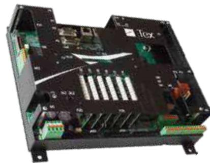
Controllo PAC (Programmable Automation Controller) che include funzioni HMI + PLC + Motion Control fino a dodici assi interpolati, estesa connettività al campo inclusi EtherCAT e Mechatrolink come opzioni.
