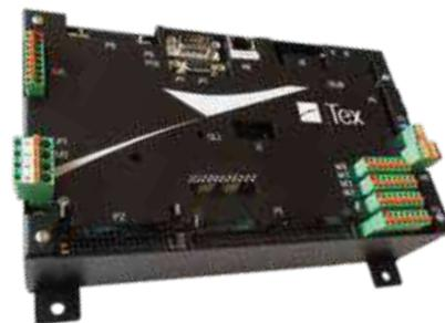
Controllo PAC (Programmable Automation Controller) che include funzioni HMI + PLC + Motion Control fino a quattro assi interpolati, estesa connettività al campo, adatto per automazioni quali macchine a CNC per la lavorazione del metallo, legno, marmo, pantografi, foratrici, maschiatrici, frese, torni, pallettizzatori e altre macchine speciali...
