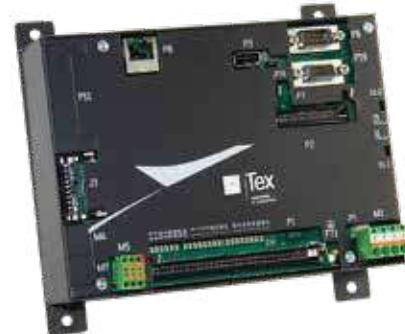
Controllo PAC (Programmable Automation Controller) che include funzioni HMI + PLC + Motion Control fino a due assi interpolati, estesa connettività al campo, adatto per piccole e medie automazioni quali troncatrici, macchine avvolgitrici, sistemi di verniciatura, macchine per calzature e lavorazione della pelle, distributori automatici, piccole macchine a CNC, sistemi di supervisione, banchi di collaudo, nastri trasportatore, teste di maschiatura e foratura, tavole girevoli, macchine speciali...
